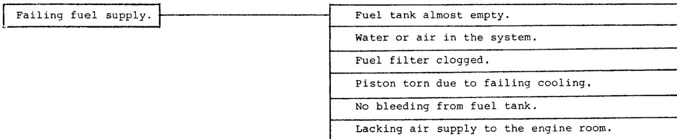
3. ENGINE DOES NOT REACH MAXIMUM CAPACITY
