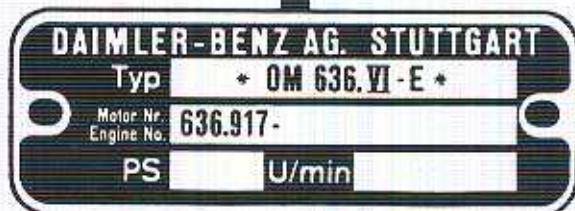
Das Motor-Nummerschild befindet sich auf der rechten Seite am Kurbelgehäuse vom, hinter dem Kraftstoff-Filter.
