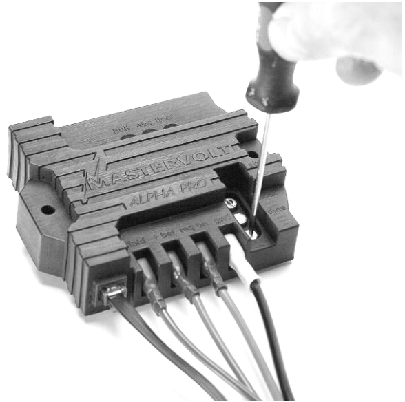
Afbeelding 14: Afregelen van de potentiometers
