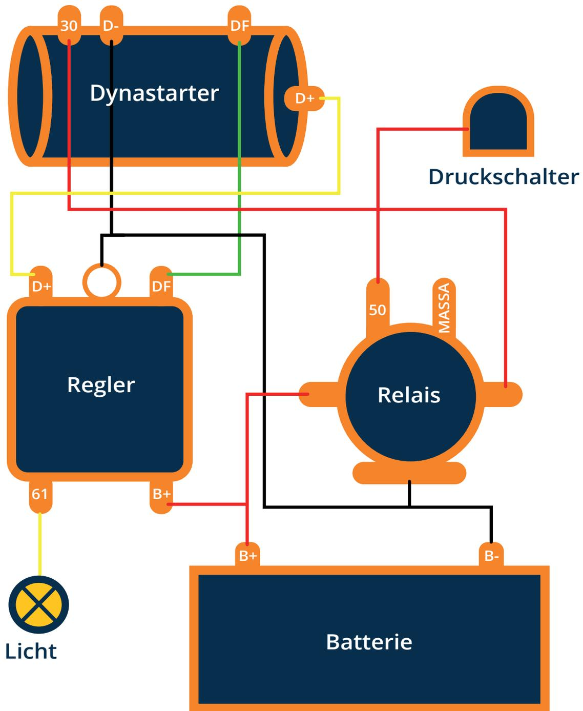
Hinweis: Vertauschen Sie nicht die Polarität und vertauschen Sie die Drähte nicht, während der Regler an Spannung angeschlossen ist. Die Spannungsquelle für Licht- und Druckschalter wird vom Zündschloss aus geschaltet. Der Dyna-Starter funktioniert am besten bei hoher Geschwindigkeit. Bei niedriger Geschwindigkeit kann das Licht schwach brennen
